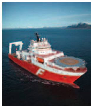
Far Samson är 121,5 meter lång, 26 meter bred och kan frakta upp till 6 130 ton.
