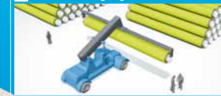
Rör som viktbelagts med betong lagras på var och en av de fem strategiskt placerade lagerplatserna längs dragningen.
