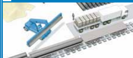
Rören når Mukran och Kotka via tåg och fartyg. Cement, magnetit, sand och aggregat levereras för betongbeläggningen.
