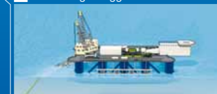
Ombord på rörlägningsfartyget svetsas rören samman för att sedan sänkas ned på havsbotten.
