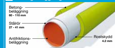
Varje rör på 12,2 m får en betongbeläggning som dubblar rörets vikt till 20–30 ton. Vikten ger stabilitet på havsbotten.
