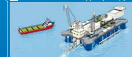
Transportfartyg levererar kontinuerligt rör till rörlägningsfartygen för att upprätthålla ett 24-timmars konstruktionsschema.
