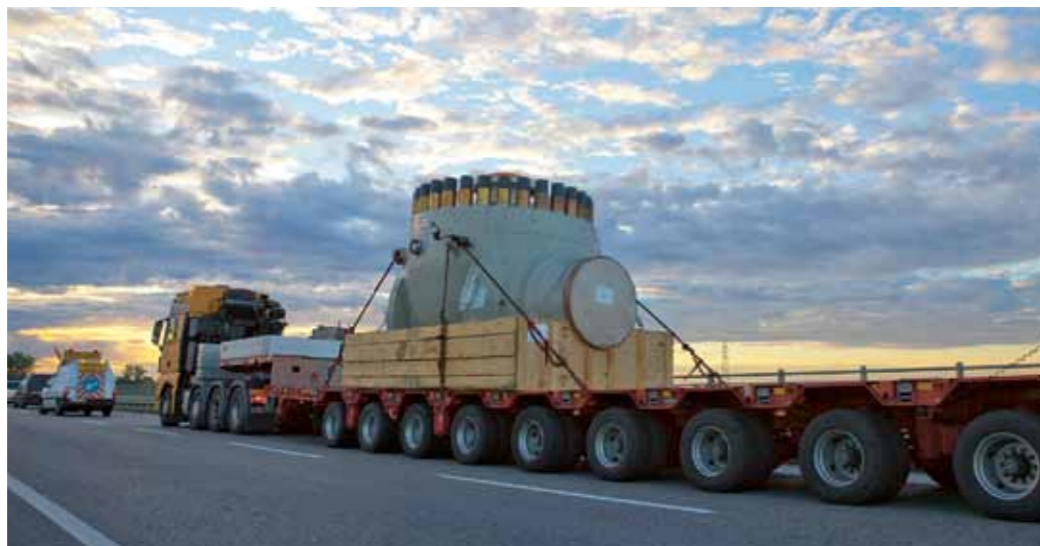
Vägtransport av 100 ton komponenter genom Europa fordrar noggrann planering och särskilda tillstånd.
